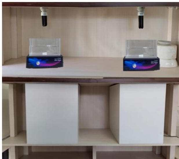
Gambar 2. Fotoreaktor Uji Fotodegradasi di Bawah Sinar Lampu UV
