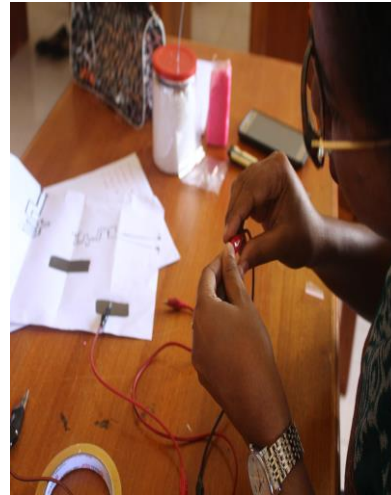
Gambar 3. Pembuatan rangkaian listrik menggunakan pensil 2B dan 6B dengan cara menggambarkan rangkaian listrik pada selembar kertas menempelkan LED pada tem kemudian menyambungkannya dengan penjepit buaya dan dilihat LED akan menyala.
