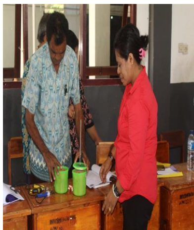
Gambar 1. Para guru dibimbing dalam membuat kalorimeter sederhana dengan memanfaatkan toples plastik, gelas aluminium, dan serbuk kayu sebagai bahan isolator untuk menghambat proses aliran kalor.
