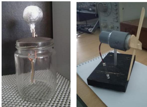
**Gambar 1.** Prototype alat peraga sederhana elektroskop dan konversi energi.
