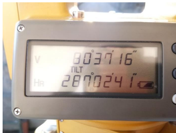
Gambar 3. Satuan sudut Jarak Zenith dan Azimuth yang Terukur pada Theodolite
