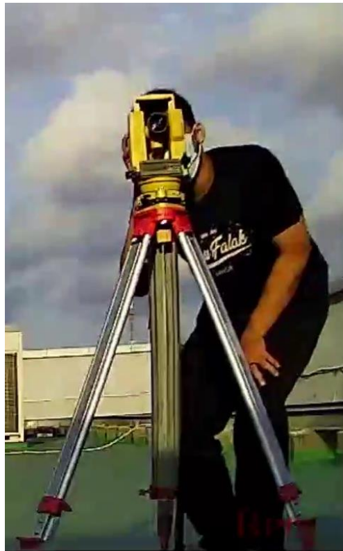
Gambar 2. Pengamatan menggunakan Theodolite
