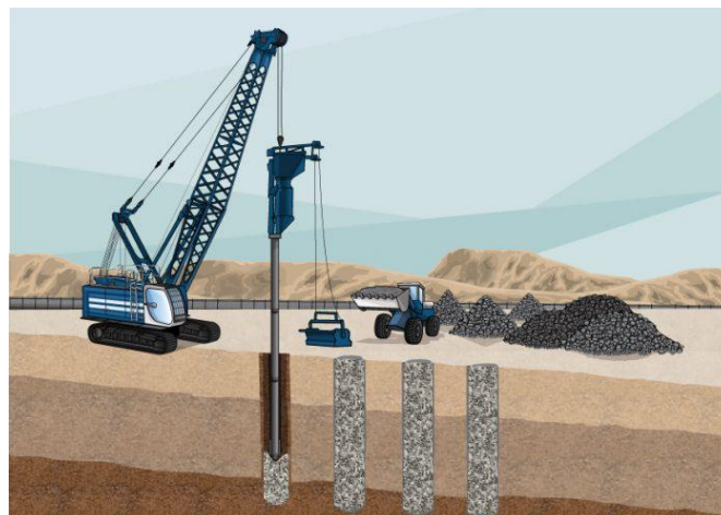
Gambar 4. Stone Column Menggunakan Teknik Vibro Displacement
