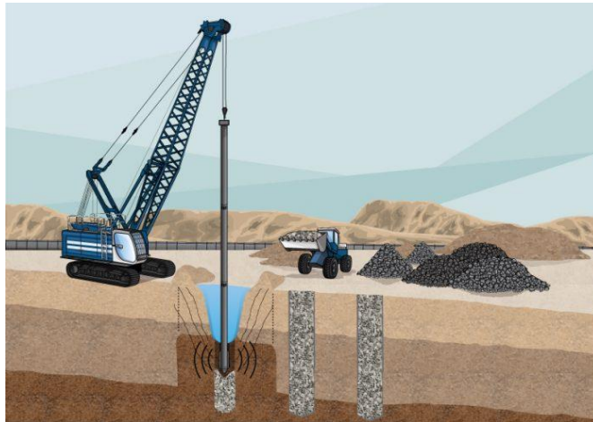
Gambar 3. Stone Column Menggunakan Teknik Vibro Replacement
